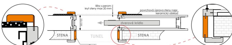
Šírka v rozsahu nad 20 mm sa nastavuje tak, že sa rozšíria jednotlivé komponenty rámu dverí – tunel (príplatok).
